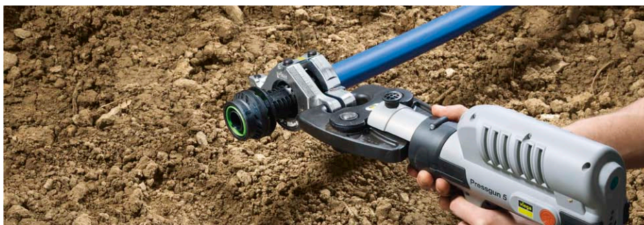
3. Verbinder verpressen und grüne Verpressanzeige kontrollieren.
