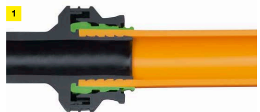
Die innenabdichtende Kontur der Geopress K-Verbinder macht ein Dichtelement überflüssig.
